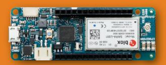
Arduino MKR GSM 1400 wurde entwickelt, um eine praktische und kostengünstige Lösung für Hersteller anzubieten, die ihre Projekte mit minimaler Erfahrung in der Vernetzung um eine globale GSM-Konnektivität erweitern möchten. Es basiert auf dem Atmel SAMD21 und einem SARAU201 GSM-Modul.
