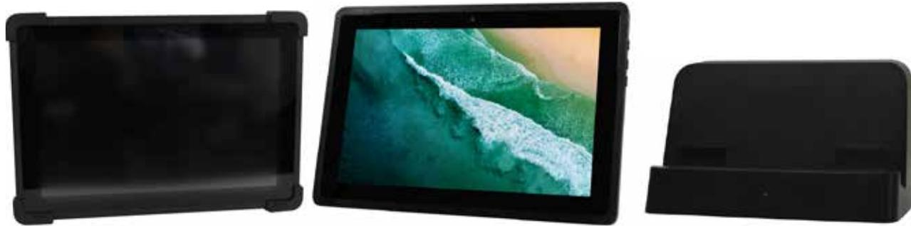
Los displays robustos son especialmente adecuados para un uso intensivo, por ejemplo, en la gastronomía o la logística. La base de carga tiene 2 puertos USB para ratón y teclado así como una conexión de red PoE a través de la cual también se pueden cargar las tablets. En cuanto se retira el dispositivo de la base de carga, pasa automáticamente a la conexión WLAN.
