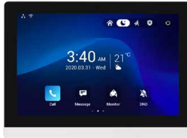
El ALLNET DS10 es un display especial para la integración en centrales telefónicas y porteros automáticos. La integración SIP permite integrar el display como un teléfono en una centralita, por ejemplo, Fritz Box, 3CX, etc. También es posible configurar el display como una centralita.
