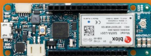
El Arduino MKR GSM 1400 está diseñado para proporcionar una solución práctica y rentable para los fabricantes que buscan añadir conectividad GSM global a sus proyectos con una mínima experiencia en redes. Está basado en el Atmel SAMD21 y un módulo GSM SARA-U201.
