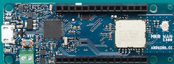
Arduino MKR WAN 1300 fue diseñado para proporcionar una solución conveniente y rentable para los fabricantes que buscan expandir sus proyectos con conectividad Lo-Ra y una experiencia de red mínima. Está basado en el Atmel SAMD21 y un módulo Murata CMWX1ZZABZ Lo-Ra.
